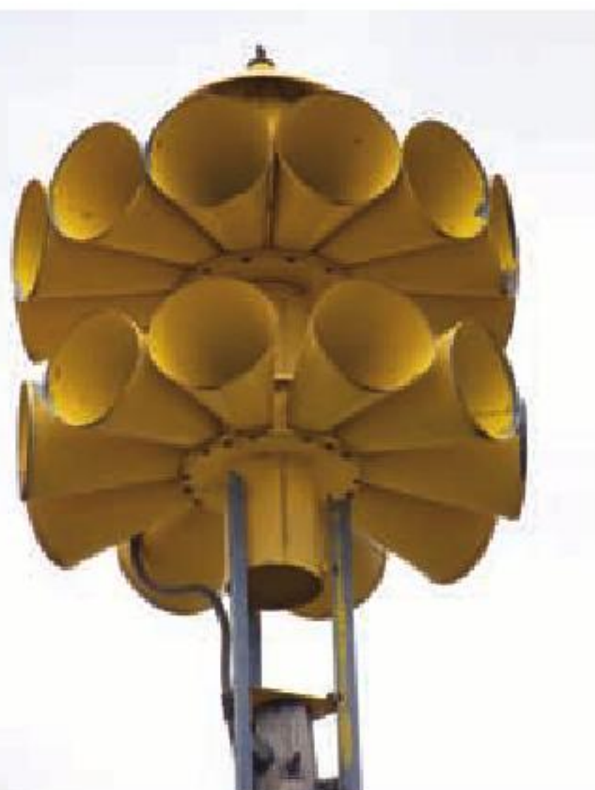
Sirena de tornado. Advierte a los residentes que se acerca un tornado.
